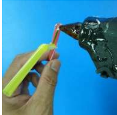
圖 7. 用熱熔膠將簡易塑膠吸管上端封閉
